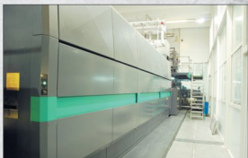
В этой камере при температуре 850 градусов сушится краска.
