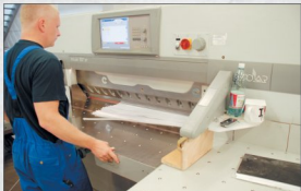
Гильотина для обрезки бумаги включается двумя кнопками. Еще бы: если будешь неосторожен, руку отрезает на счет «раз!». По бокам, правда, есть предохранители, которые при нажатии в рабочей зоне посторонних предметов блокируют гильотину.
